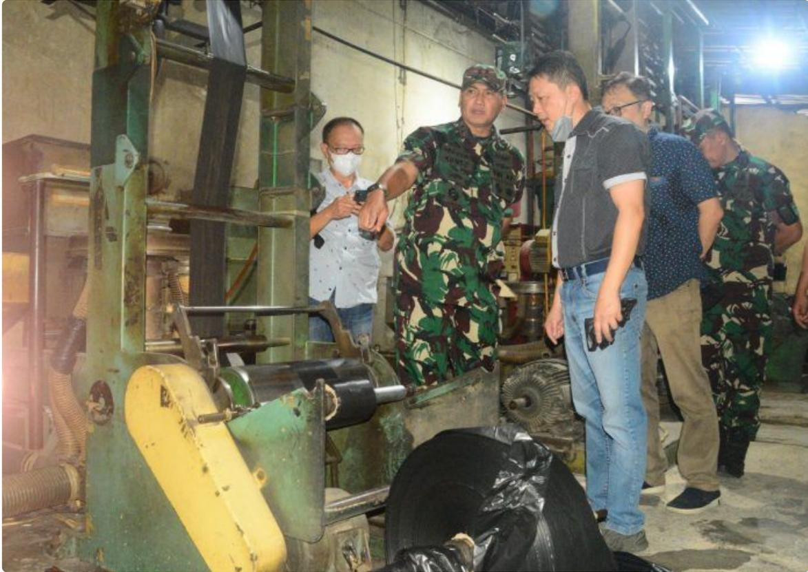
Direktur Operasional Amerta Cakra Lestari Surya Suhendy mengatakan spesifikasi mesin pencucian daur ulang limbah plastik 1 unit mesin rajang basah, 1 unit bak rendam plastik sebelum dicuci, 1 set mesin cuci plastik hak cipta, 1 unit spinner dan 1 unit mesin pengering.
